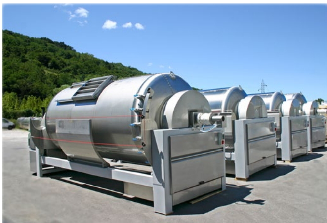
buben typu PST s propojenými odtokovými kanálky, velký odtokový povrch
