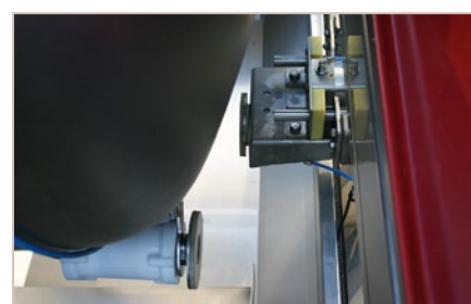
Konektory bubnu a rámu lisu – přerušované propojení
